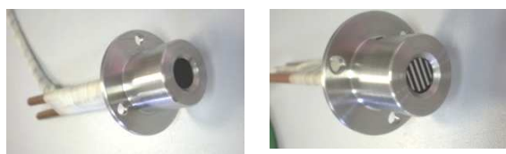
Fig. 5 : Fluxmètres total et radiatif avec circuit de refroidissement en eau
