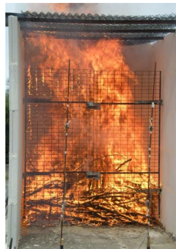
Fig. 3 : Panneau radiant du caisson
